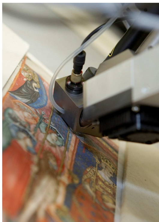
Fig. 7. Analyse d'un folio enluminé par XRF
