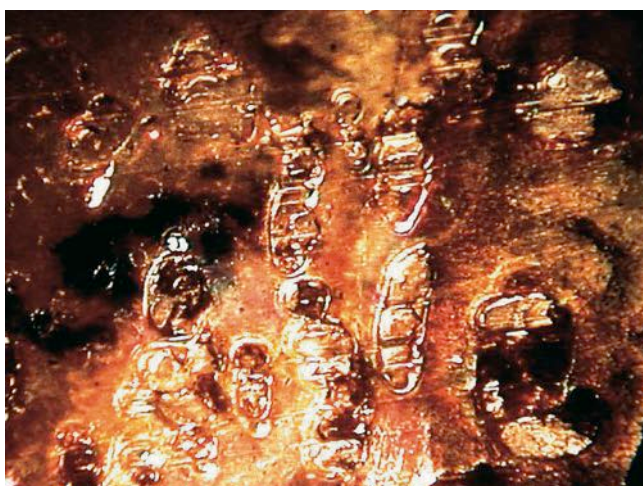
221. Attaque du verre de doublage par la corrosion. Aantasting door glascorrosie van het doubleerglas.
