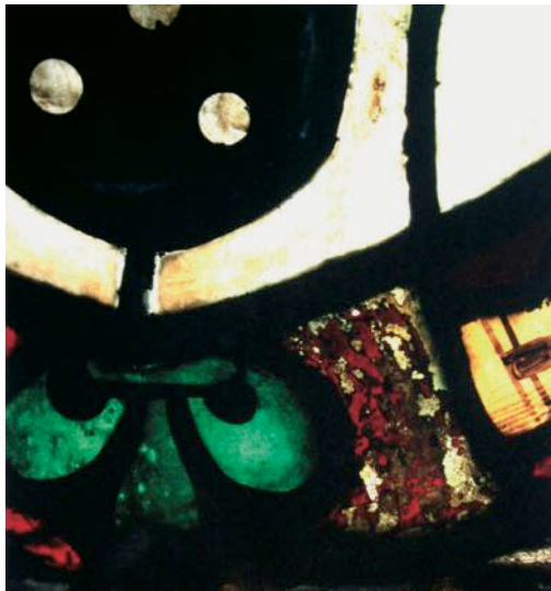
216. Attaque par la corrosion de la couche plaquée de rouge. Aantasting van de rode plaquélaag door glas-corrosie.
