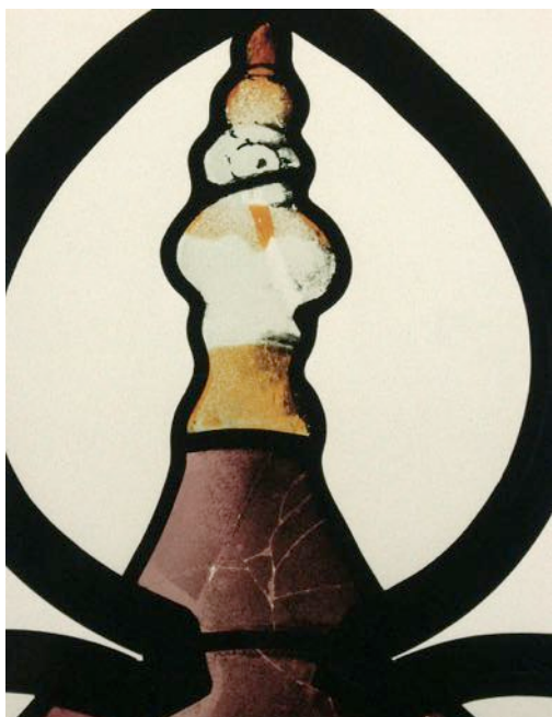
216. Attaque par la corrosion de la couche plaquée de rouge. Aantasting van de rode plaquélaag door glas-corrosie.
