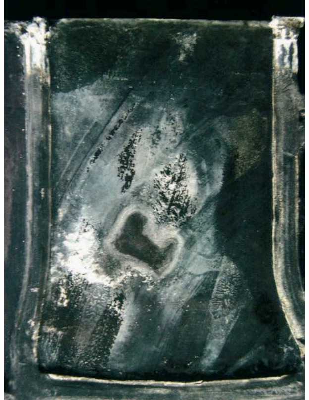
220. Salissures dues à des spores de champignons et à des résidus de corrosion entre le verre et le doublage. Verontreiniging door schimmelsporen en corrosieproducten tussen de doublures.
