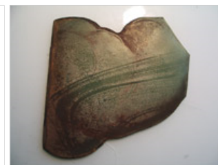
Fig. 7 : Pièce du vitrail de la Crucifixion de Scry avec reliefs soulignés par la corrosion (cliché I. Lecocq).
