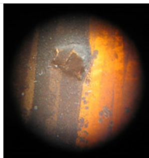
Fig. 2 : Inclusion dans une pièce de verre (cliché I. Lecocq).
