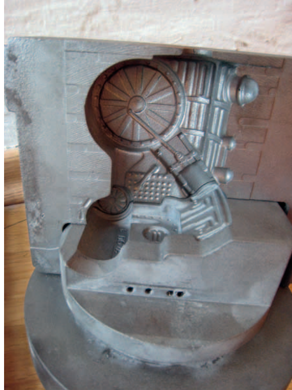
Fig. 11a-b. Moules actuels pour flacons de parfumerie (Nouvelles Verreries de Momignies). © J.-P. Delande.
