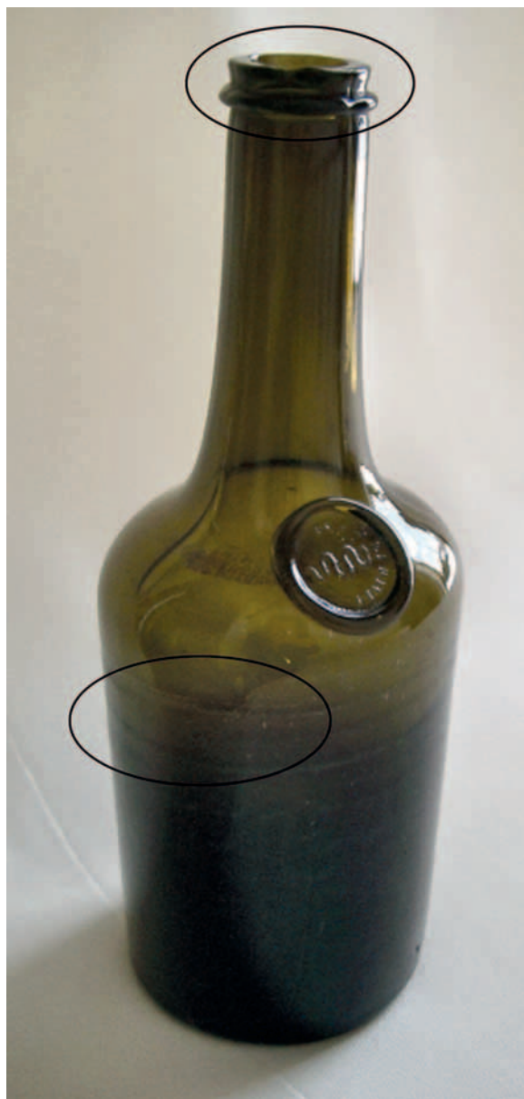
Fig. 5. Bouteille médicinale (?) du début du xix e siècle (Coll. privée, H. : 19 cm). Les traces de soufflage en moule de fond selon la méthode du soufflé-tourné sont parfaitement visibles sur le bas de la pièce, plus particulièrement sous l'épaule. Au sommet, la lèvre du goulot est nette de tranchage puis doucie au feu. Grâce aux fers à embouchures, la cordeline et l'écart entre celle-ci et la lèvre ont été standardisés. © J. Falconnet-Séris.
