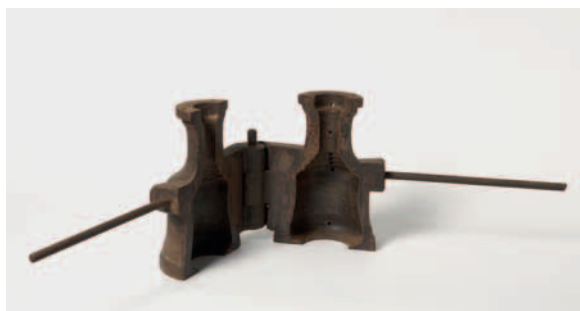
Fig. 68 a-b. Moule bivalve pour flacon, en fonte, percé de petits événements, destiné à des formes soufflées-tournées, XIX e siècle; présenté fermé et ouvert (Coll. privée, L avec poignées : 50 cm). © KIK-IRPA, Bruxelles, J.-L. Elias, Xo18684 (fermé) et Xo18683 (ouvert).
