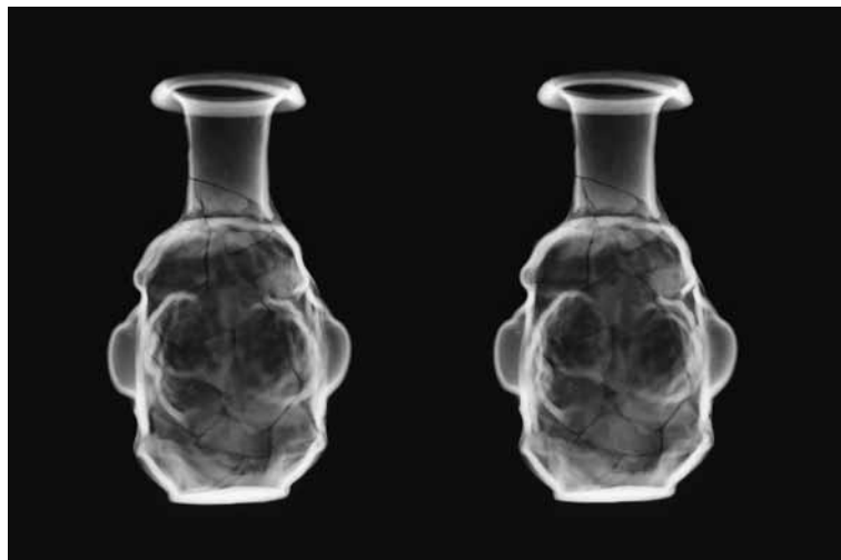
Fig. 4. Avant restauration, stéréoradiographie du flacon révélant le réseau de cassures sous-jacent au surpeint. © KIK-IRPA, Bruxelles, C. Fondaire et G. Van de Voorde.
