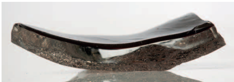
Fig. 5. Vue macroscopique de la coupe d'un tesson, montrant le doublage interne rouge grenat et la fissuration de toute l'épaisseur du verre clair. © KIK-IRPA, Bruxelles, J.-L. Elias.
