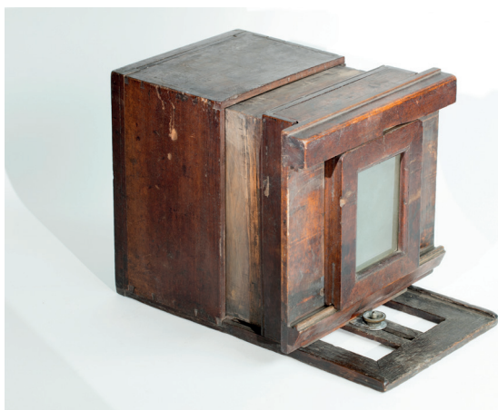
Fig. 14a. Petite chambre au collodion à tiroir.
