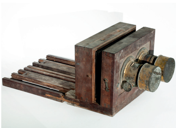
Fig. 16. Chambre pour collodion de Leclaire.
