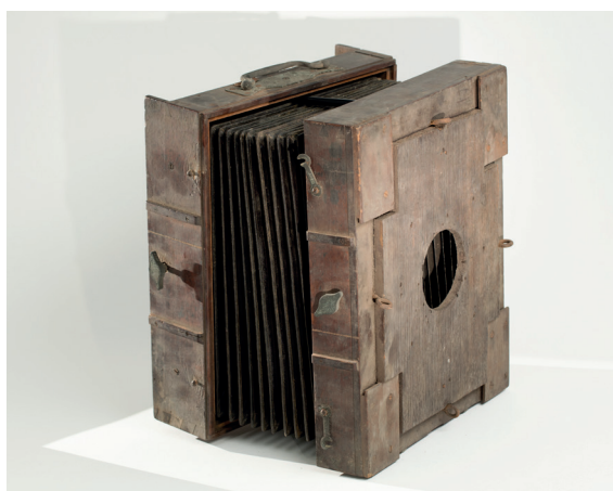
Fig. 15. Chambre au collodion pour plaques 21x26 cm.
