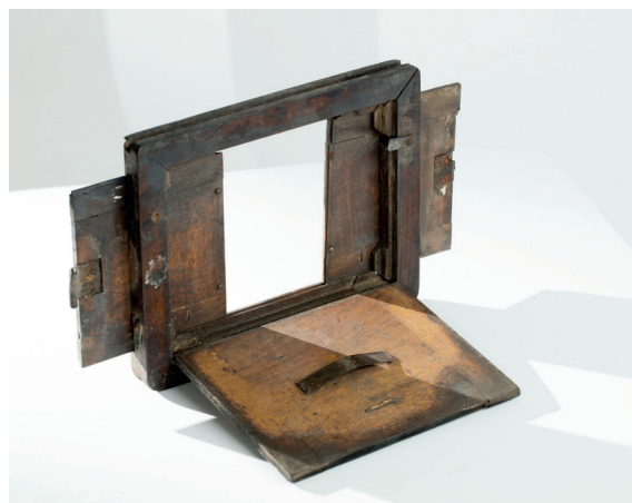
Fig. 14b. Châssis à deux tirettes, pour réaliser successivement deux prises de vues différentes sur une plaque. Le volet arrière est muni d'une tige métallique formant ressort pour presser la plaque dans la batée.
