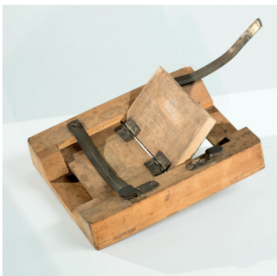
Fig. 34. Châssis-pressé pour l'impression des positifs à la lumière du jour.
