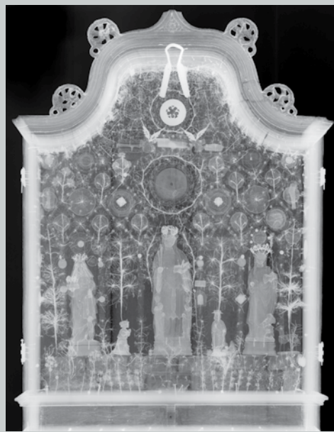
Fig. 5 : Radiographie du Jardin clos avec saintes Elisabeth, Ursule et Catherine (voir fig. 1) : les subtiles structures en métal des tiges et des fleurs sont clairement visibles.
