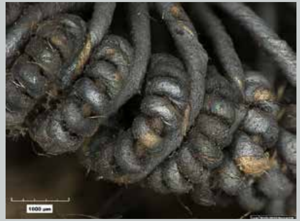
Fig. 7 : Détail d'une image prise au microscope numérique 3D du coeur d'une fleur (détail de la fig. 4) en argent autour d'une fibre textile. L'argent s'est corrodé sous l'effet de la pollution.
