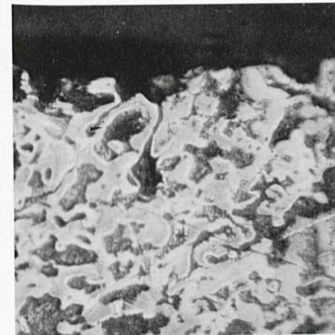
8. Micrografie 259× van geëst metaalmonster met diep doorgedrongen patina van de boord naar het midden toe (zwarte vlekken). (Grafplaat. Brugge, Begijnhof.)
