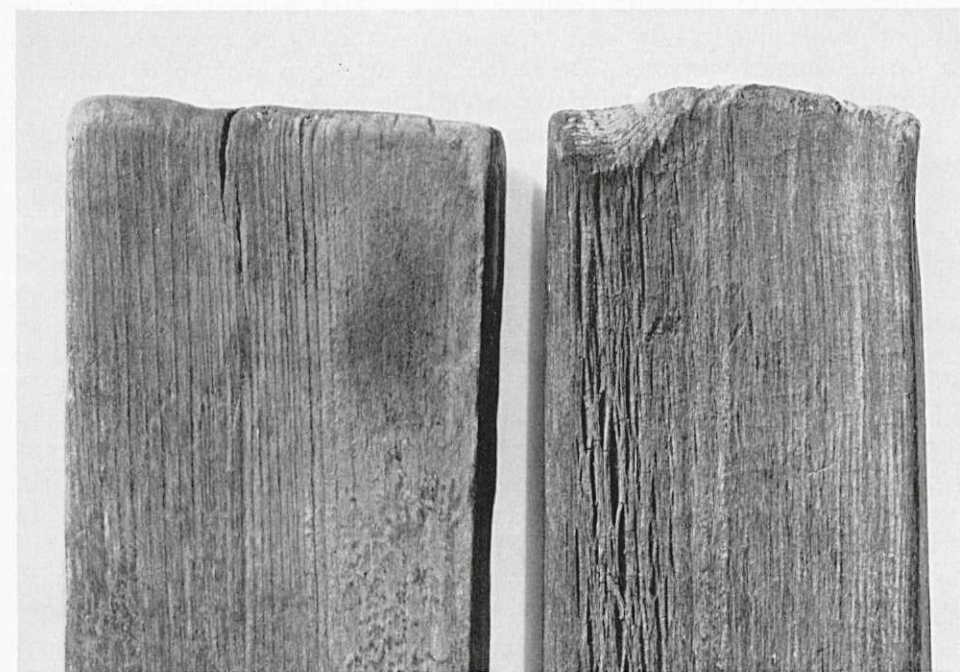
3. Detailfoto's, links : behandelde duig; rechts : zonder speciale voorzorgen gedroogde duig.
