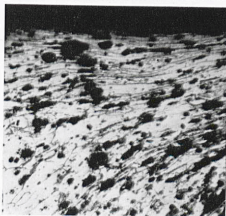
55. Micrographies 88 ×, 88 × et 120 × de la structure de ferrite non déformée à l'extrémité des vis des types I et II (en haut et au milieu) et de la structure écroutie de la vis moderne cisailée (en bas).
