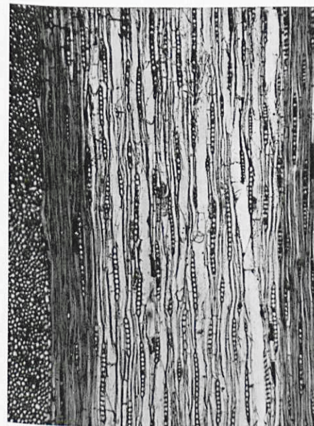
45. Micrographie 47 x : coupe tangentielle du bois du panneau central.
