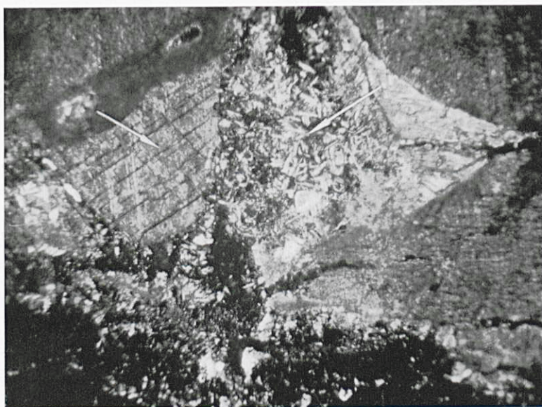
10. Micrographie en lumière verte, nicols croisés, 56x : structure superficielle d'une pierre d'Euville avec encroûtement gypseux mettant en évidence la corrosion d'un débris d'encrine spathisé (à droite) et la formation de nombreux microcristaux de gypse (à gauche).
