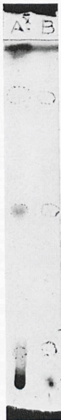
4. Chromatogrammes sur couche mince des solutions chloroformiques des fractions non solubles (A) et solubles (B) de la colle Rubens dans l'eau.
