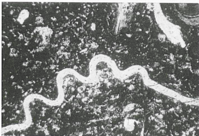
10. Carrière Delwart à Barges. Calcaire de Pont à Rieu, veine de Première : fragment de brachiopode associé à des débris de bryozoaires et de crinoïdes (grossissement 40 ×).
