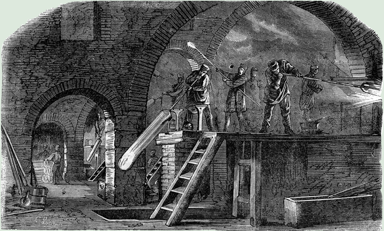
[Fig. 7] Soufflage de canons (extrait du Journal pour tous , n° 830, 13 septembre 1865, p. 768, Collection privée).
