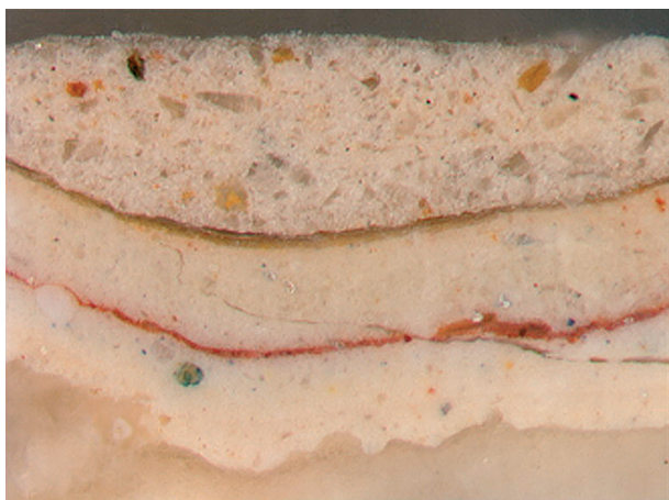
10 Rez-de-chaussée, salon à front de rue. La coupe (C72.169) montre les deux interventions rouge et ocre. Gelijkvloers, salon aan de straatkant. De dwarsdoorsnede (C72.169) toont de twee ingrepen: rood en oker.
