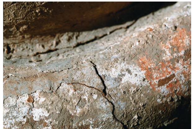
21 Rétractation et soulèvement de bouchages en pâte à bois largement débordants, avec arrachement de matière originale. Gekrompen en opgestuwde, ruim overlopende opvullingen in houtpasta die de oorspronkelijke materie losrukken.
