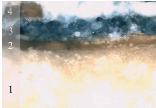
21 La coupe stratigraphique de la dalmatique de saint Laurent photographiée sous lumière blanche réfléchie avec un grossissement 750 ×. On peut y observer la préparation (1) imprégnée d'une couche d'isolation (2) sur laquelle se trouve une couche d'indigo mélangé au blanc de plomb (3) et un fragment d'une couche organique, probablement de vernis (4).
