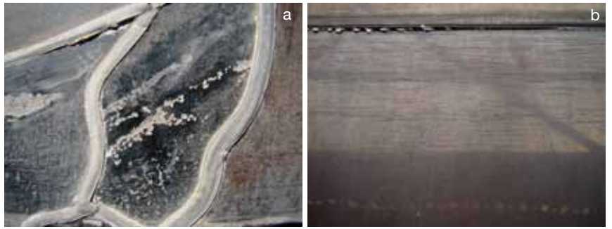
Fig. 19.- Corrosion du verre : a) sous forme de cratères : vitrail de Marguerite de Hornes (SIII) ; b) sous forme de griffes : vitrail de Jean de Cromois (I). © Isabelle Lecocq.
