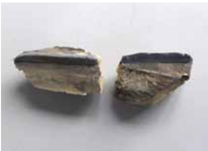
Fig. 28.- Pose de mastic sur des fragments de tuffeaux pour contrôler la migration éventuelle de méthyl silicone dans le matériau pierreux.
