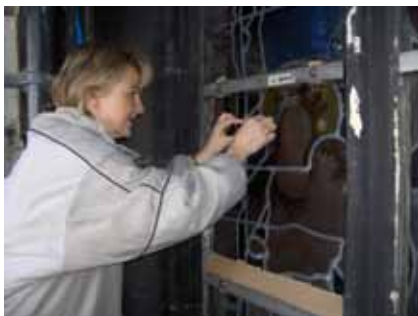
Fig. 40.- Placement de senseurs par le Fraunhofer-Institut für Silicatforschung de Würzburg (Allemagne). © Isabelle Lecocq.
