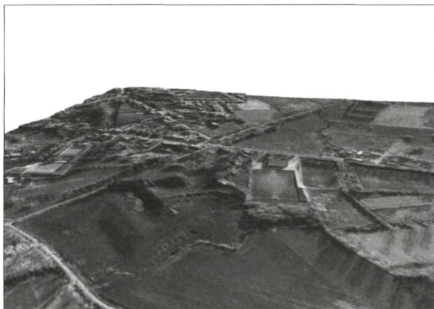
Voorbeeld van 3D visualisatie met gebruik van het Digitaal Hoogtemodel Vlaanderen (DHMV) en orthofoto's (versterking bij Zoutleeuw)
