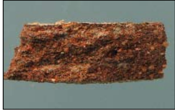
Figure 78: fresh break of a misfire Figuur 78: baksel van een misbaksel van Tongeren
