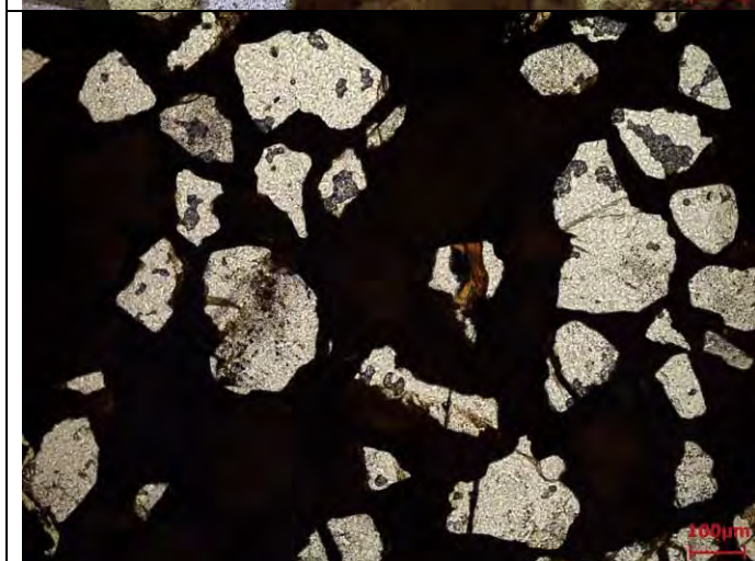
Figuur 29. Detailopname van de Figuur 27 in het dicht limonietcement (staal D5.1B).
