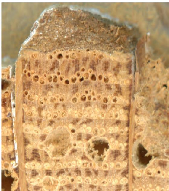
Fig. 4a. Derniers cerne de croissance avec écorce en place sur le complément d'échantillonnage. Détail du plan transversal de l'échantillon 606/P686/03/006, collé sur un support et après préparation et étude dendrochronologique. © auteur : A. Weitz, photo de travail IRPA, 2021.
