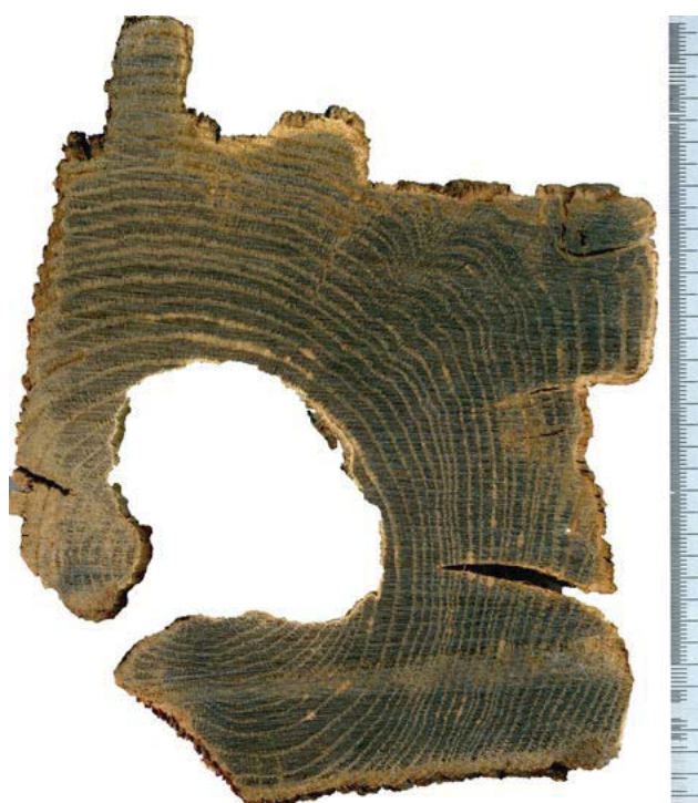
Fig. 31. Section de poutre de fondation, réemployée d'une baie de pan-de-bois, Place Maurice Servais, Namur. Photo: Labo Dendro IRPA, photo de travail, 2016 © IRPA, Bruxelles
