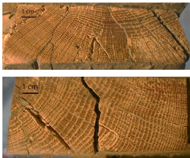
Fig. 14 – Sommets des deux montants latéraux intérieurs des vantaux, après ponçage de la surface transversale du bois pour rendre visibles les cernes de croissance
