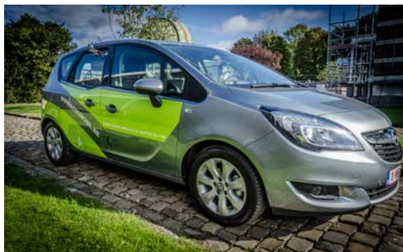
Figure 3 : Voiture de l'IASB équipée de l'instrument Mobile-DOAS. La tête optique, sur laquelle sont fixées les fibres optiques, est installée sur la fenêtre arrière. Le spectromètre et l'ordinateur sont à l'intérieur de la voiture.
