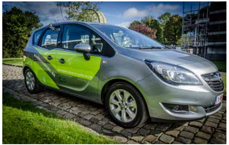
Figuur 3: De meetwagen van het BIRA, uitgerust met het mobiele DOAS-instrument. De optische eenheid, die via glasvezelkabels verbonden is met de spectrometer, is op het raam van één van de achterdeuren gemonteerd. De spectrometer en de bijbehorende computer bevinden zich in de laadruimte.
