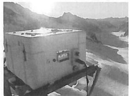
Fig. 3 : L'instrument SAOZ à la station internationale du Jungfraujoch
