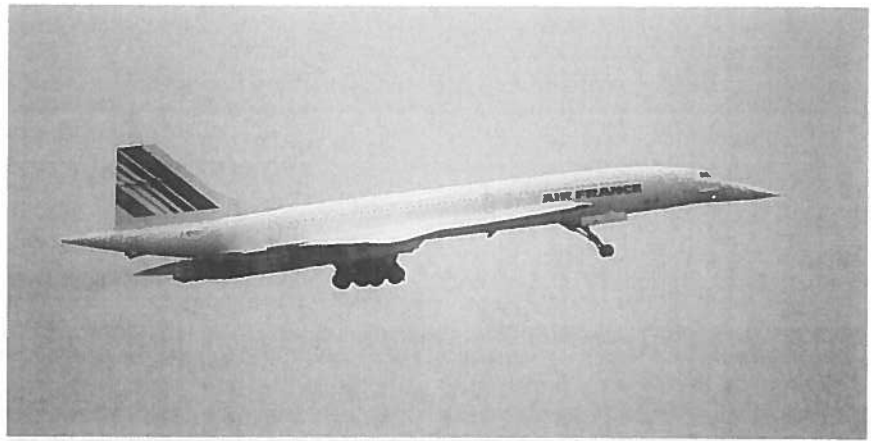
Fig. 3: Décollage d'un Concorde lors d'un vol commercial, l'échappement montre clairement une traînée rouge due à la transformation instantanée du monoxyde d'azote en dioxyde d'azote à la surface. Cette production élevée d'oxyde d'azote reflète le très haut rendement des réacteurs OLYMPUS de Concorde. (Image par Philippe Noret).
