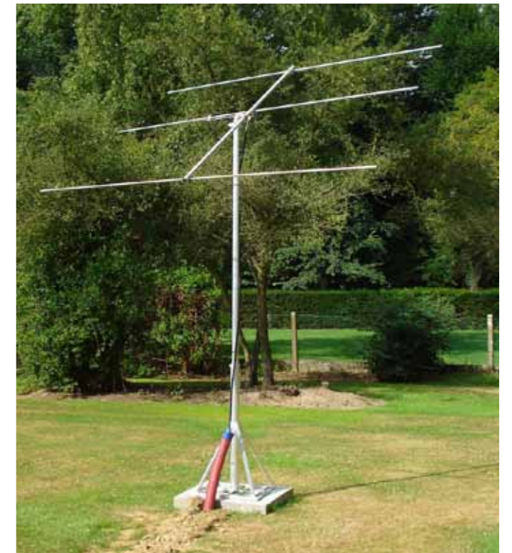
Antenne réceptrice située à Uccle (antenne Yagi avec 3 éléments)
