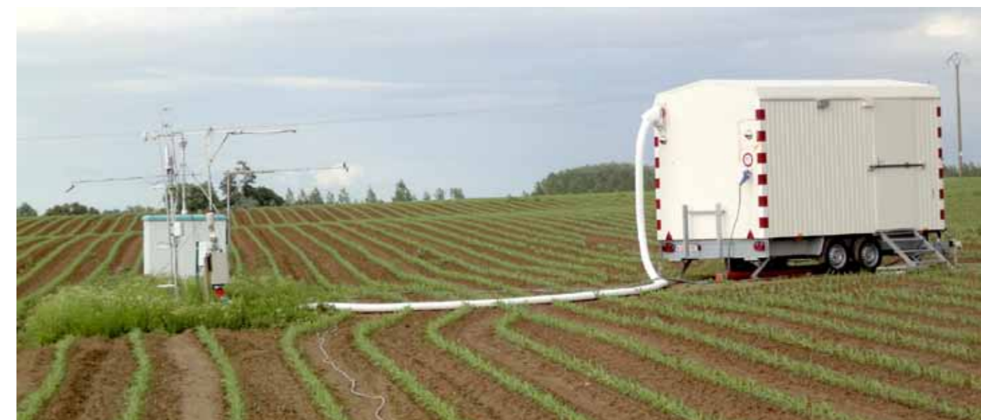
Setup de mesures de flux par eddy covariance au milieu d'un champ de maïs à Lonzée
