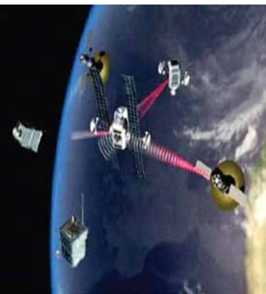
Een illustratie van hoe een 'System F6' cluster van kleine satellieten zou samenwerken om dezelfde mogelijkheden te bieden als één enkele grote satelliet. Foto: DARPA en parabolicarc.com .
