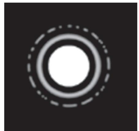
Fig. 4. Figure de diffraction dans un télescope
