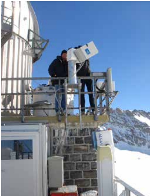
Figuur 7: Sedert 2010 gebruikt het BIRA een MAX-DOAS-instrument op Jungfraujoch. Hier vervangen onderzoekers Christian Hermans en Frederik Tack enkele onderdelen van het instrument. © High Altitude Research Stations Jungfraujoch and Gornergrat
