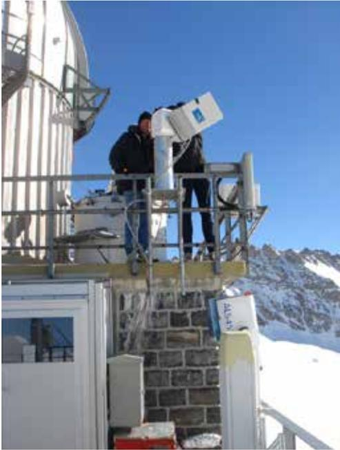
Figure 7 : Depuis 2010, l'IASB utilise l'instrument MAX-DOAS au Jungfraujoch. Sur cette image, les chercheurs Christian Hermans et Frederik Tack remplacent quelques éléments de l'instrument. © High Altitude Research Stations Jungfraujoch and Gornergrat
