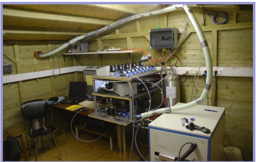
Figuur 9: PTR-MS and bijhorende experimentele opstelling in de loghut aan de voet van de meettoren
