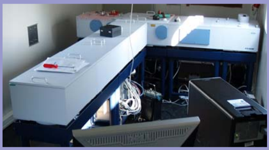
Figuur 5: Fourier transform spectrometer (IFS 125 HR model) die in het infrarood werkt en op Île de la Réunion geïnstalleerd is.
