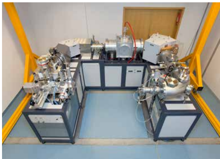
Le MICADAS du laboratoire de datation radiocarbone de l'IRPA.
