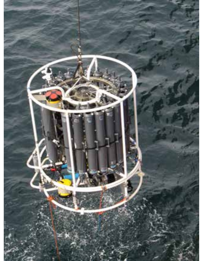
Tewaterlating van de CTD-rosette. Deze bestaat uit een frame waarop verschillende 12 liter Niskin-bemonsteringsflessen gemonteerd staan, samen met sensoren voor conductiviteit – temperatuur – diepte, alsook met een opwaarts en een neerwaarts kijkende acoustic doppler current profiler (voor het meten van stromingssnelheden) (KEOPS 2-campagne).
