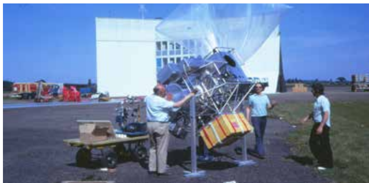
La nacelle Astrolabe, prête pour le lancement, attachée à un ballon stratosphérique, avec à son bord un spectromètre infrarouge conçu et construit par l'IASB.
