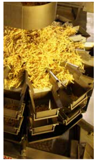
Installation de pesage pour l'ensachage © Belgapom
