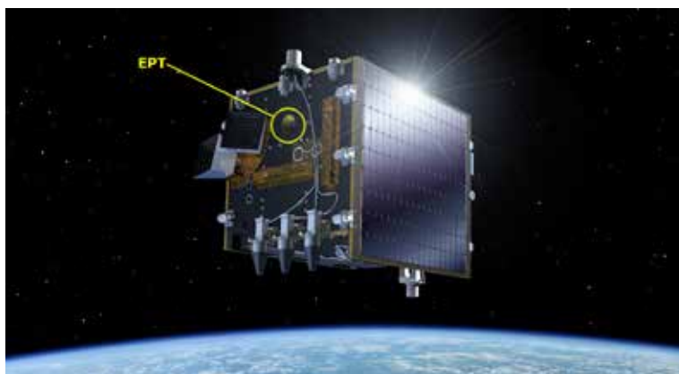
L'instrument Energetic Particle Telescope (EPT), développé par un consortium dont l'IASB et intégré au satellite de l'ESA, PROBA-V. © ESA
