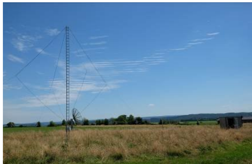
Figuur 3. Magnetische antenne geïnstalleerd in Humain in België tijdens de winter van 2010-2011. Een meethut met de datalogger en de computers bevindt zich rechts. Foto: Darrouzet.
