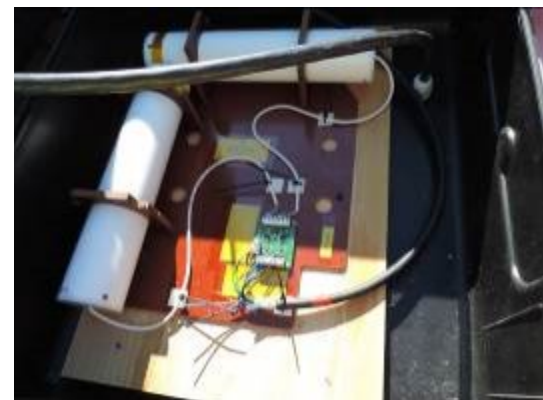
Figuur 4. Plastiëne doos met het meetinstrument. De twee magnetische spoelen zijn loodrecht op elkaar gepositioneerd, in de noord-zuid en oost-west richting. Foto: Darrouzet.
