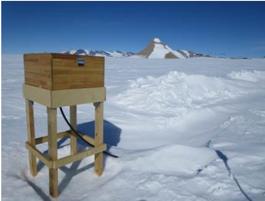
Figuur 7. Instrument vastgemaakt op een houten tafel, zelf gebed in 1 meter sneeuw en ijs. In de verte rechts onderscheidt men de windmolens van de Prinses Elisabethbasis. Foto: Darrouzet .
