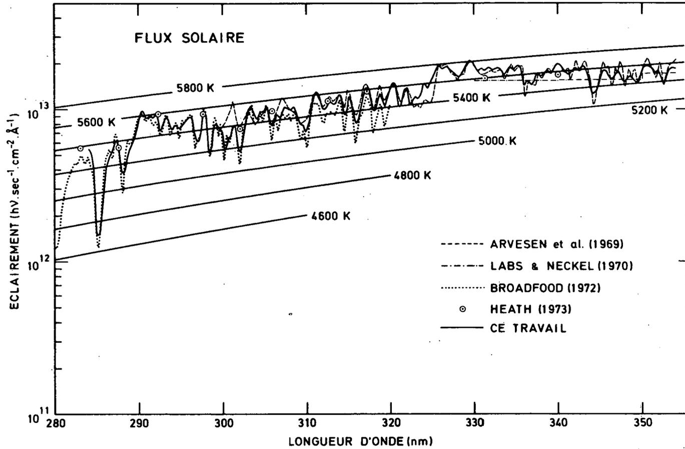
Fig. 5.- Comparaison des flux solaires mesurés par différents auteurs entre 280 et 360 nm. Les flux pour différentes températures du corps noir sont également indiqués.
