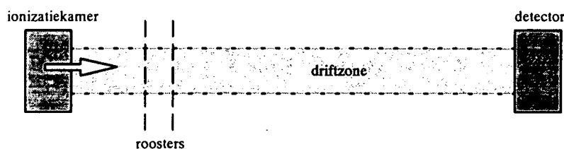
Figuur 2.10: Principe van een vluchttijdmassascheider [Jaya 66].
