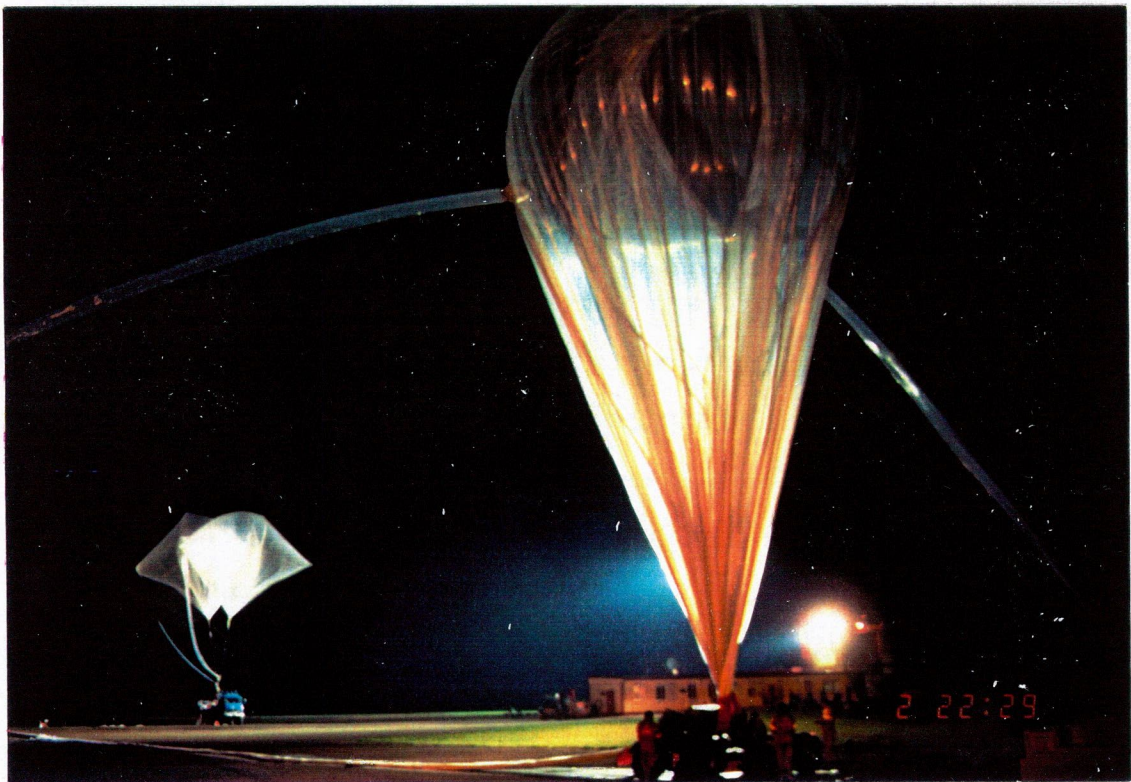
Figuur 5.1 : Afbeelding van een stratosferische ballon net voor de lancering. Op de foto ziet men eveneens de hulpballons die het instrument van de grond tillen om schade bij de lancering te voorkomen (foto CNES).
