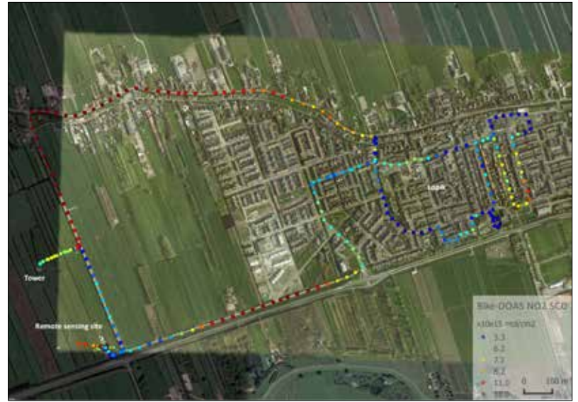
Figuur 8: Kaart met \text{NO}_2 kolommen rond de meet-site in Cabauw, gebaseerd op metingen met een compact DOAS-instrument, gemonteerd op een fiets.
