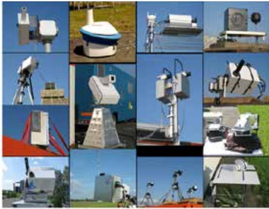
Figuur 2: Mozaïek van verschillende types (MAX-)DOAS-instrumenten die tijdens CINDI met elkaar worden vergeleken. © A. Piters, KNMI
