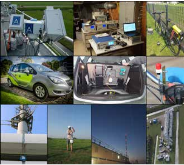
Figure 7: Mosaïque de différents instruments utilisés pendant CINDI-2. De gauche à droite, de haut en bas: IASB-BIRA MAX-DOAS, ensemble de capteurs in situ ( \text{NO}_2 , \text{SO}_2 , \text{O}_3 , etc.), IASB-BIRA BikeDOAS, IASB-BIRA Aeromobil, IASB-BIRA senseur à \text{NO}_2 , KNMI radiosonde \text{NO}_2 , RIVM mobile LIDAR.
