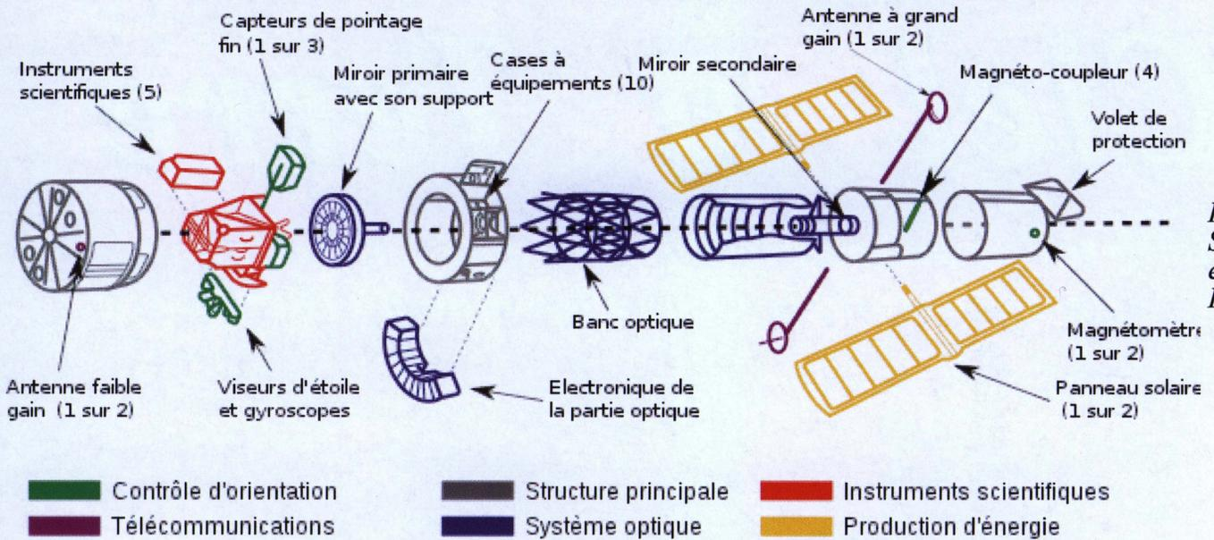
Figure 2 : Schéma éclaté du HST.
