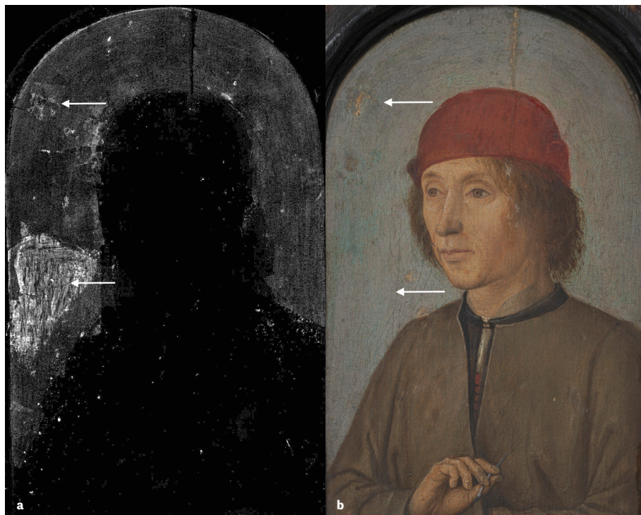
13.a. De MA-XRF scan voor goud. 13.b. Foto van het portret, genomen voor de restauratie in juni 2020. De onderste pijl op de twee afbeeldingen geeft de plaats aan waar nog goud aanwezig is. Het kleurt wit op de MA-XRF-opname. De bovenste pijl wijst naar de plaats waar oorspronkelijk wellicht een wapenschild was.
