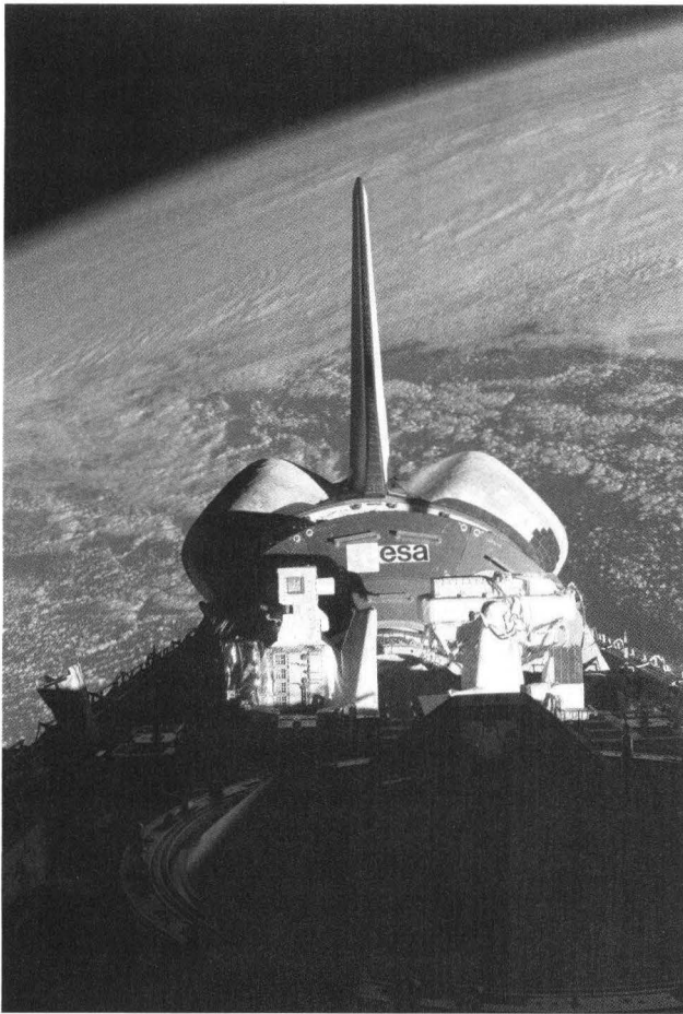
Fig.4 : Le laboratoire COLUMBUS en vol dans la soute de la navette ATLANTIS, les charges utiles extérieures EUTEF (à gauche) et SOLAR à droite, transférées à part, sont installées en vol lors d'une sortie. (Document NASA).
