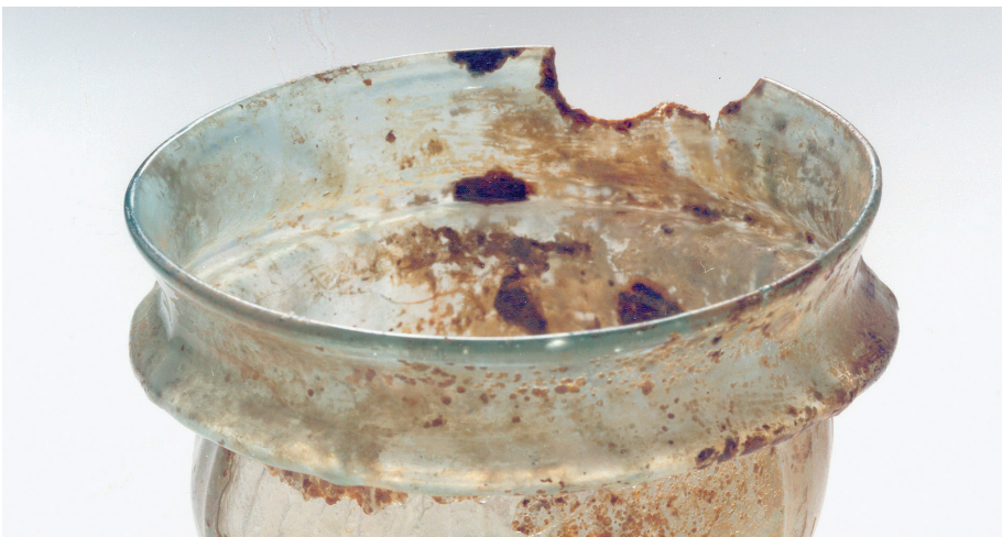
11. L'altération fragilise le verre. La coupe de ce calice médiéval, piquetée de brun, est déjà rongée en bordure.
