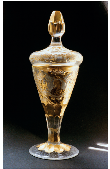
12. Verre pleurant. Les petites gouttes agglutinées sur le pied de ce verre du XVIII e siècle trahissent son instabilité chimique. Un conditionnement spécifique doit lui être réservé.
