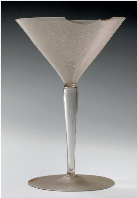
40. Ce calice vénitien retient en surface les résidus des copeaux de bois dans lesquels il a été conservé pendant de longues années. Ces résidus hygroscopiques ont amorcé une attaque ponctuelle du verre par piquetage.
